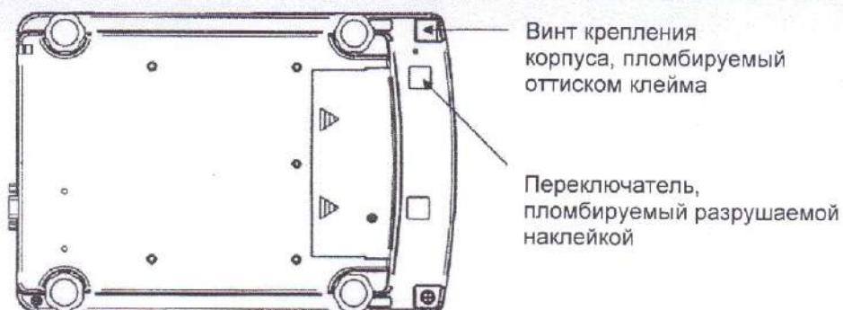
Рисунок 2 – Схема пломбирования весов от несанкционированного доступа
