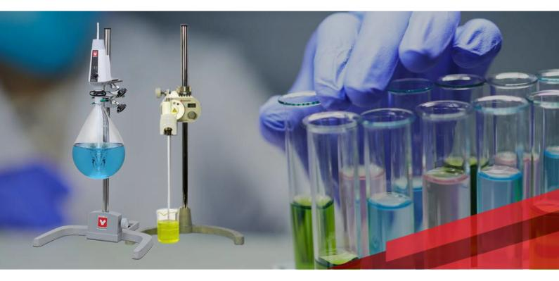
Бесщеточные двигатели, как правило, стоят дороже, но при этом Вам не нужно беспокоиться о дополнительных затратах на техническое обслуживание. Модели лабораторных мешалок Yamato **серий LM, LT и LR** снабжены бесщеточными двигателями постоянного тока.
