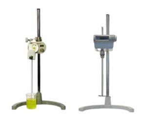
...больших объемов образцов или высоковязких веществ. Эти мешалки часто имеют полезные функции безопасности, такие как датчики, которые отключают двигатель в случае его перегрева (что может произойти при работе с высоковязкими жидкостями).
